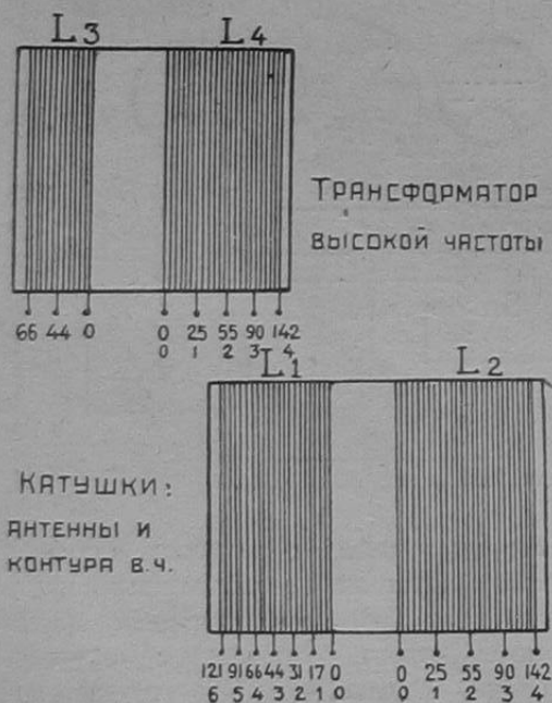
Рис. 3. Схема расположения секций катушек приемника.
